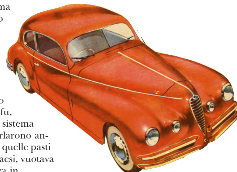
La moderna vettura italiana Alfa 2500 SS - 3 carburatori - cambio al volante - carrozzeria «Touring» superleggera in alluminio - 5 posti - gomme speciali per alta velocità.
